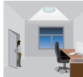
Si la lumière naturelle est insuffisante, le capteur allume automatiquement la lumière lorsqu'une présence est détectée.
